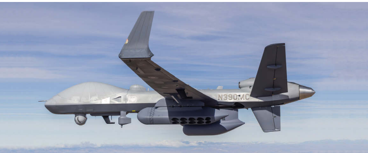
يوفر نظام مراقبة وتحكم Sonobuoy (SMCS) الخاص بطائرة MQ-9B SeaGuardian وعياً حيوياً بالمجال البحري لمهام مكافحة الغواصات.
