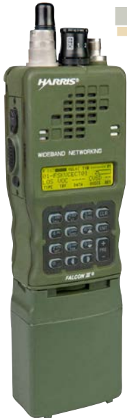
جهاز لاسلكي يدوي من AN/PRC-152 هاريس Harris
