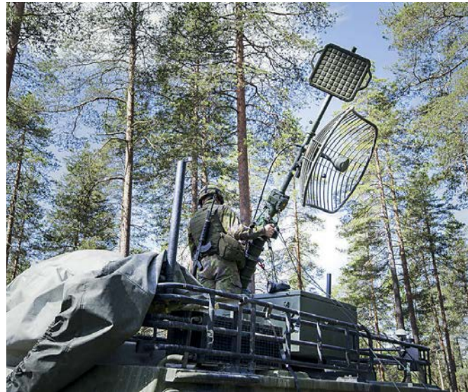
نظام الشبكة التكتيكية (TAC WIN) داخل عربة عسكرية وجهاز VOIP إنتاج Bittium
