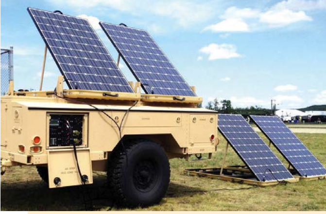
مولد الطاقة لخدمة نظام MDA إنتاج شركة «ATSC»
